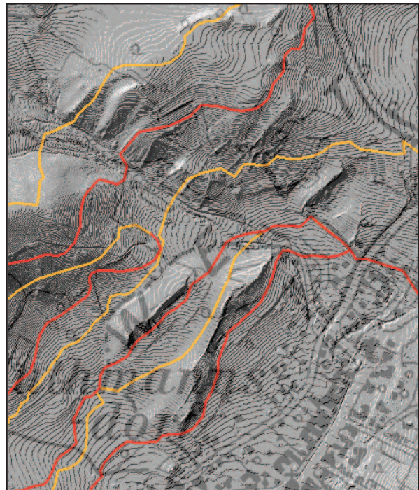
Abb. 100: Verschnitt der Isohypsen mit den Strukturlinien der Orbitoidensandsteine NNW Muthmannsdorf entlang des NW-SE verlaufenden Linsberggrabens
